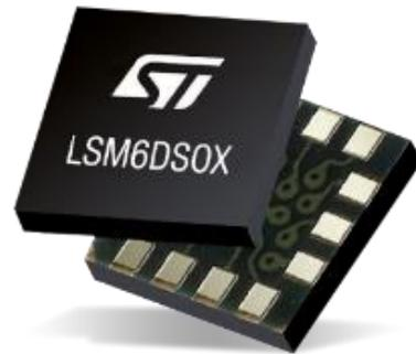
L'accelerometro e il giroscopio sono realizzati in tecnologia MEMS ed integrati in un unico package; essi costituiscono una piattaforma inerziale a 6 gradi di libertà (3 accelerazioni lineari e 3 velocità angolari), con frequenza di uscita e sensibilità programmabili in real-time.
